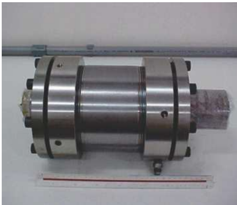
Figura 6.10 Câmara biaxial com testemunho contendo a célula triaxial em seu interior sendo preparada para os testes.
