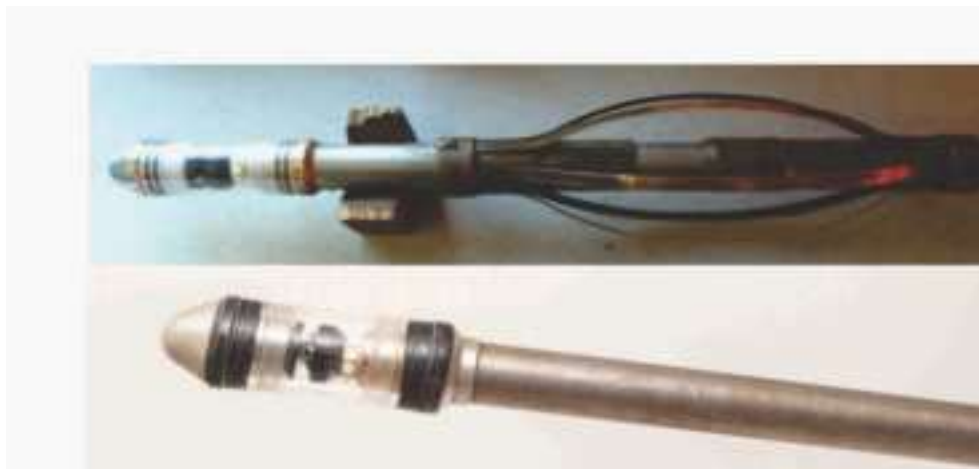
Figura 5.3 Ferramenta de imageamento ótico de alta resolução OTV ( optical televiewer ) para obtenção da orientação das hidro-fraturas induzidas no trecho de ensaio de Fraturamento Hidráulico.
