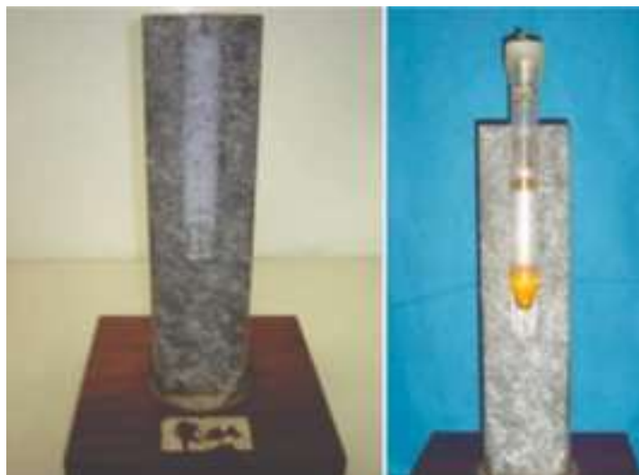
Figura 6.2 O processo de sobrefuração com furo piloto aberto (imagem da esquerda) e com célula triaxial posicionada na imagem da direita.
