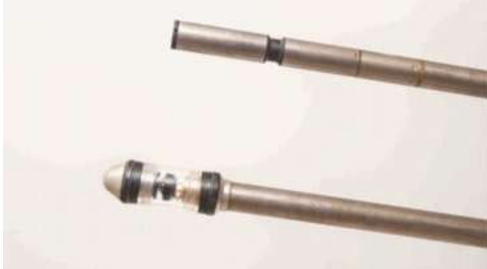
Figura 9.3 Sondas de investigação geofísica inside the hole ATV ( acoustical televiewer ) e OTV ( optical televiewer ) que aplicam os princípios acústico e ótico para se obter o imageamento e realizar análise dos breakouts .
