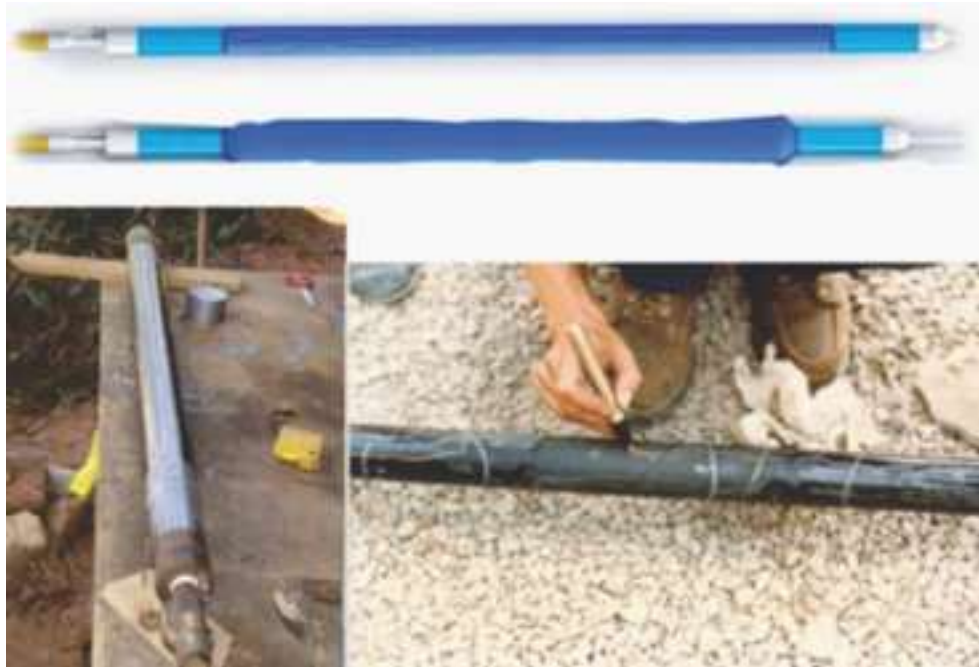
Figura 5.2 Obturador de impressão para a identificação de hidro-fraturas induzidas por ensaios de Fraturamento Hidráulico, e imagens reais de preparação do obturador e identificação das hidro-fraturas que foram induzidas.
