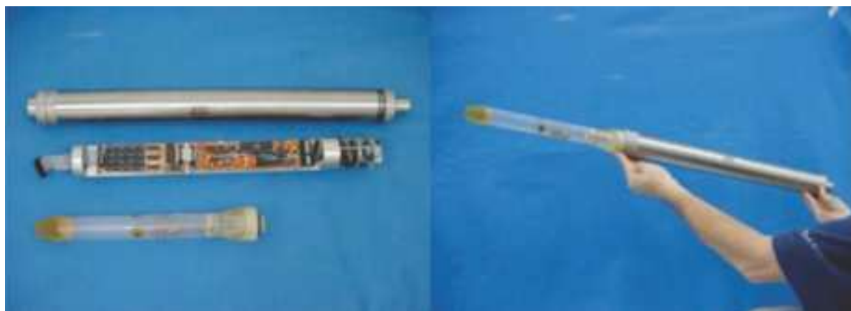
Figura 6.8 Circuito eletrônico do Módulo de Aquisição de Dados (MAD) da célula triaxial LNEC na esquerda figura e o módulo acoplado à célula triaxial na direita da figura.
