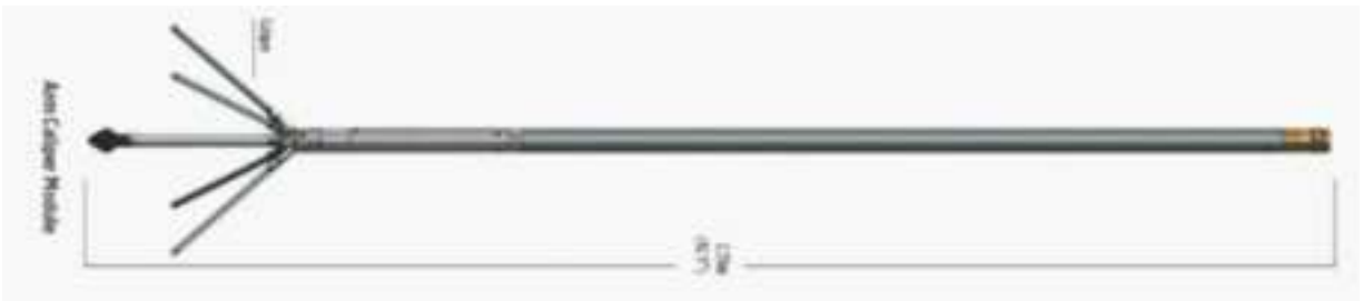
Figura 9.2 Sonda de investigação Caliper 04 ARMS que auxilia na identificação de breakouts . Fonte: imagens gentilmente cedidas pelas ROBERTSON GEOLOGGING LTD, todos os direitos reservados.
