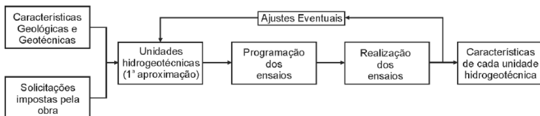
Figura 1 – Fluxograma metodológico para a caracterização das unidades hidrogeotécnicas do maciço objeto do estudo.
